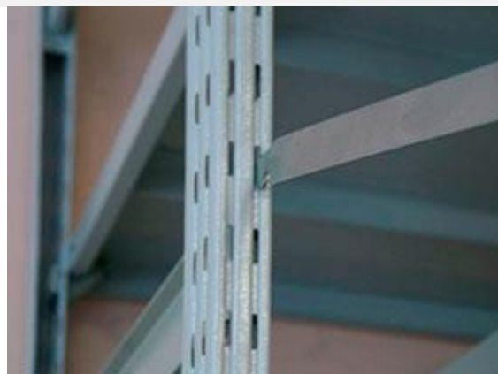
Вставьте кронштейн в отверстие стойки в верхней части стеллажа, как показано на фото.
