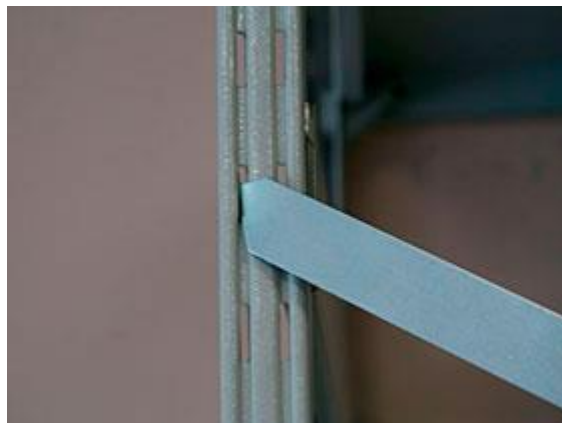
...до соприкосновения растяжки со стойкой.
